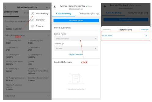
3.Geben sie den Leistungsprozentsatz ein, den sie einstellen wollen und Klicken Sie auf sendet. Wichtig ist schließlich, dass im Überwachungs-Log kontrolliert wird, ob der Befehl erfolgreich gesendet wurde
