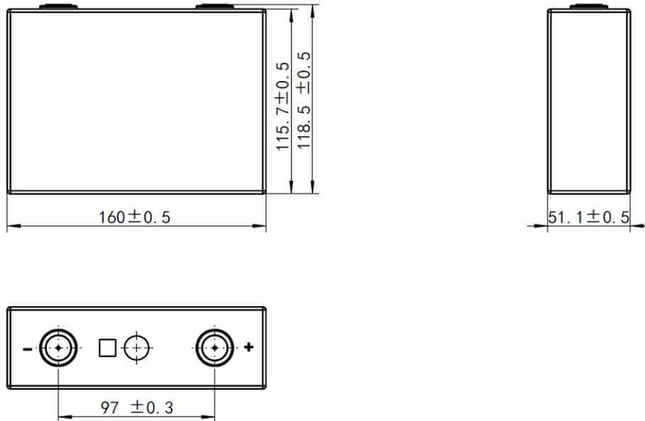
**Abbildung 4. Lithium-Ionen-Zelle in drei Ansichten (Einheit: mm)**
