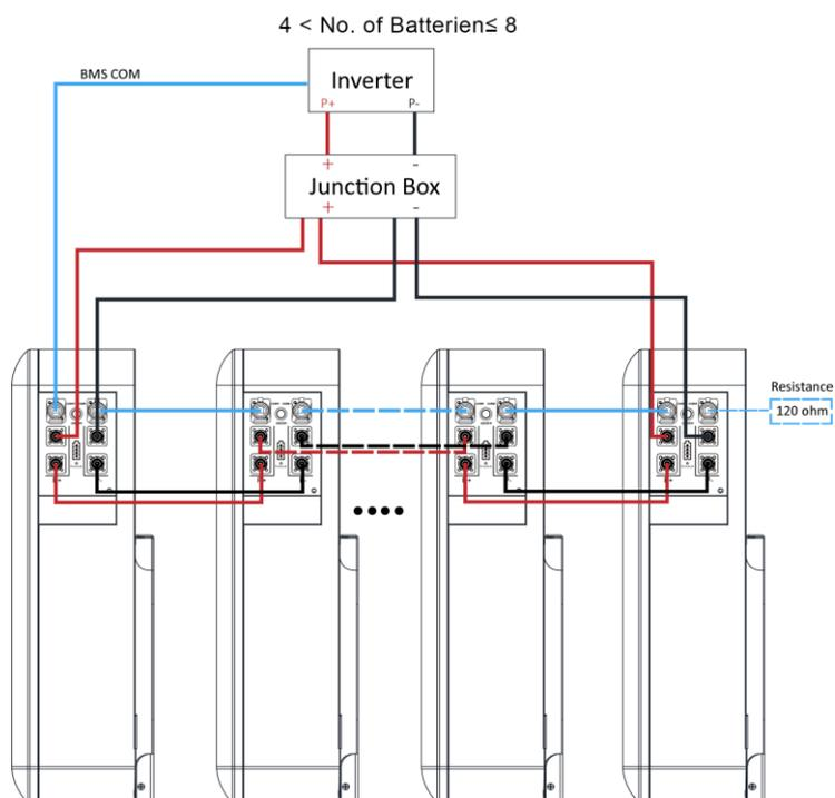
Abbildung 19. Anschließen der Kommunikationskabel (4 < Batterien ≤ 8)
