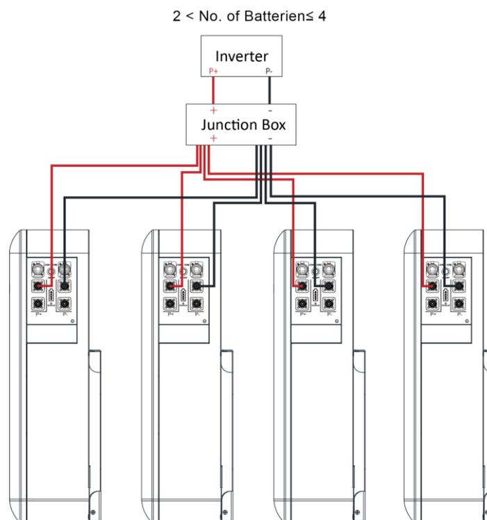
**Abbildung 14. Anschließen der Stromkabel (2 < Batterien ≤ 4)**
