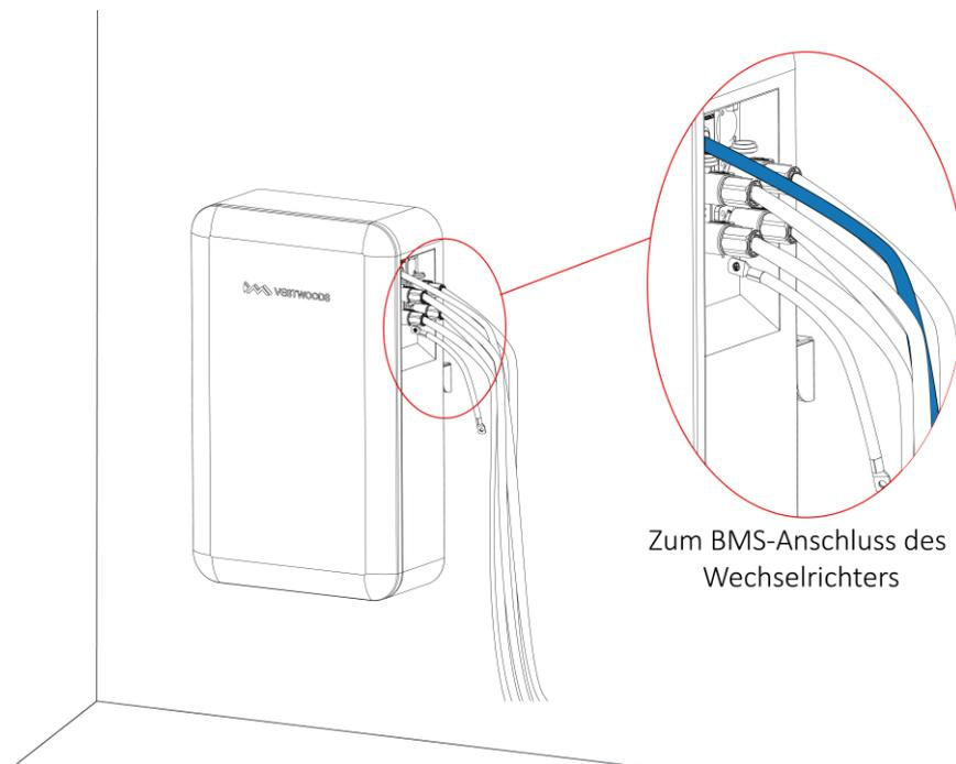
**Abbildung 16. Anschließen der Kommunikationskabel**
