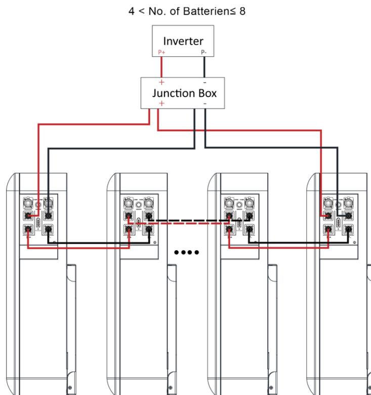
Abbildung 15. Anschließen der Stromkabel (4 < Batterien ≤ 8)
