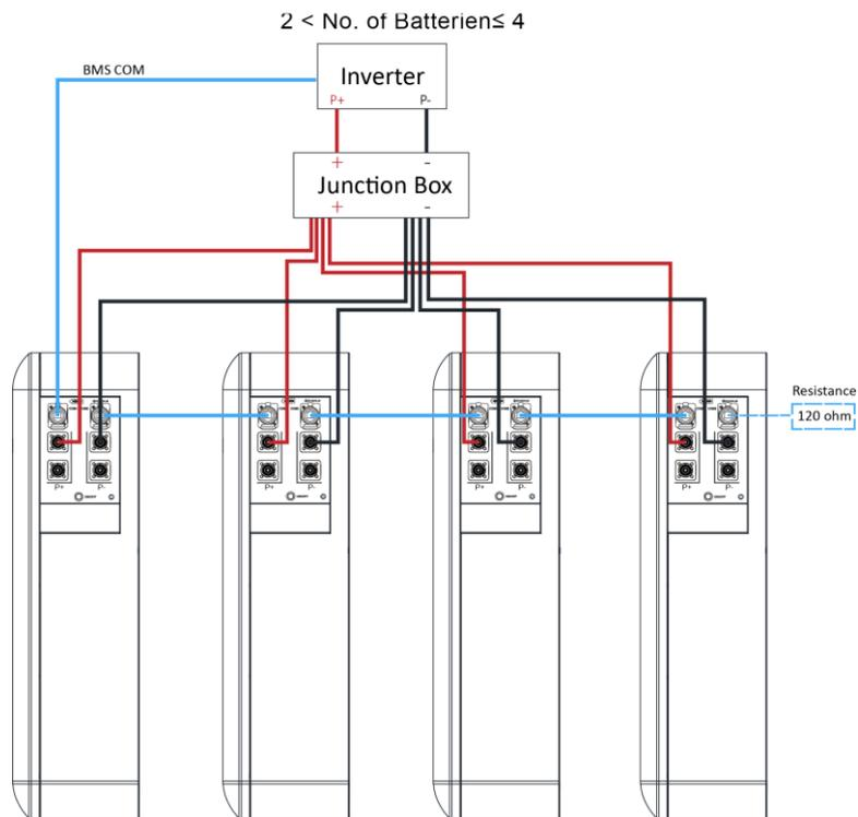
Abbildung 18. Anschließen der Kommunikationskabel (2 < Batterien ≤ 4)
