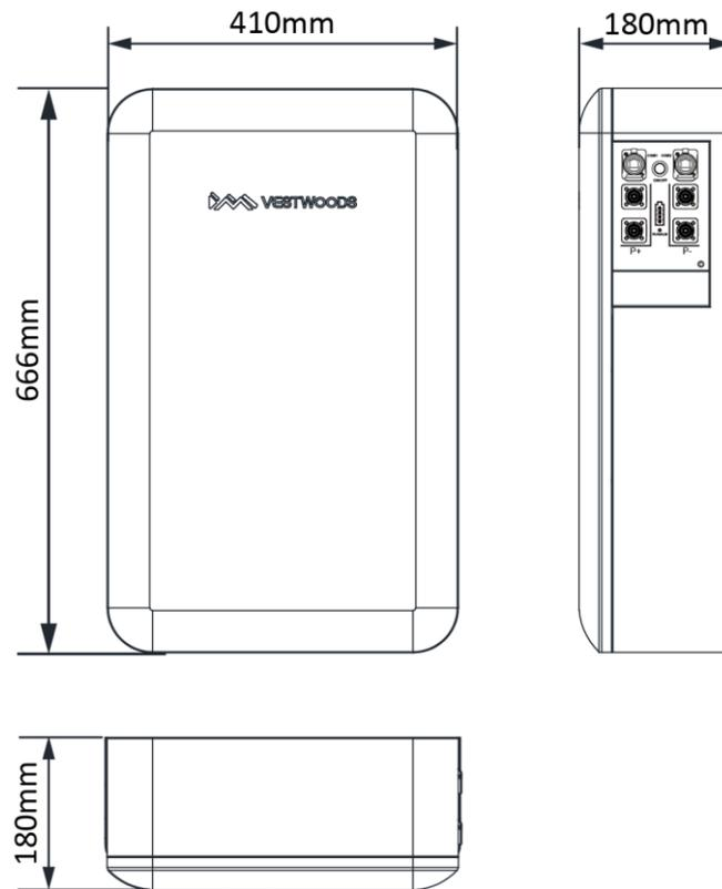
Abbildung 2. Abmessungen des V-Power S05 (Einheit: mm)
